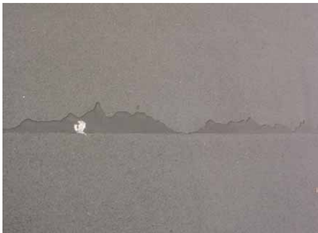
Fot. 27 Przegrzanie materiału podczas zgrzewania
